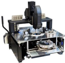
웨이퍼분석 프로브 스테이션 [Wafer Prober] 제조사 & 모델 : CascadeMicrotech, Summit11000
